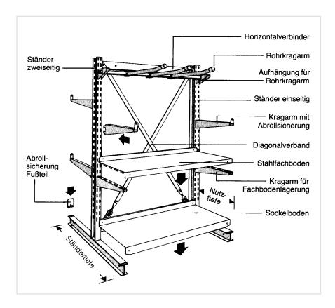
nehmer für Fachböden, oder ähnlicher Aufgaben. Vertikalstützen werden in unterschiedlichen Bauarten eingesetzt. Es gibt A- und I-Ständer sowie Fachwerkstützen. Kragarmregale werden nahezu ausschließlich aus dem Werkstoff Stahl hergestellt.
