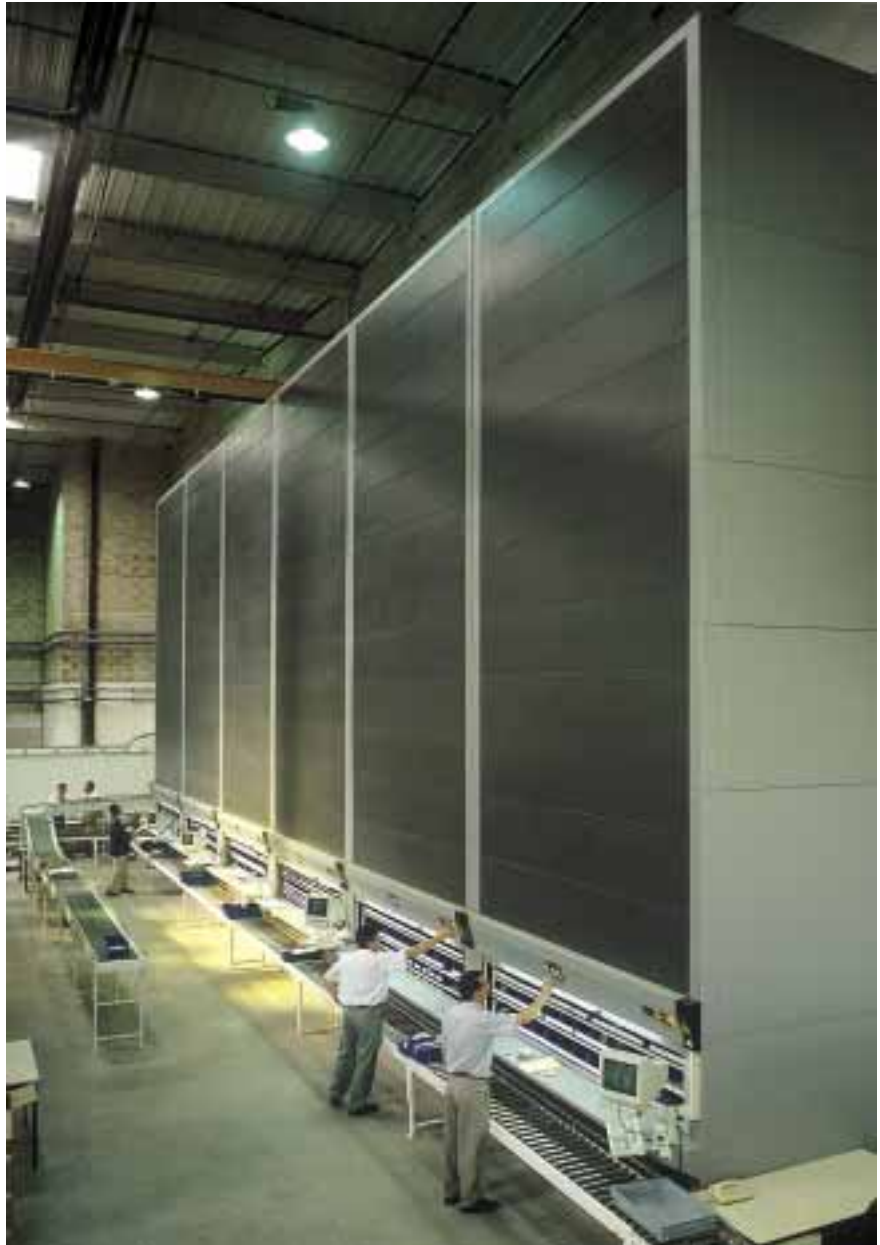
Umlaufregale mit EDV-gesteuerter Kommissionierung und Teilelogistik
