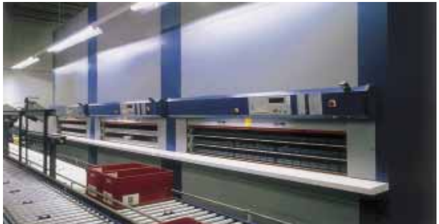
Umlaufregale im innerbetrieblichen Logistikbereich
