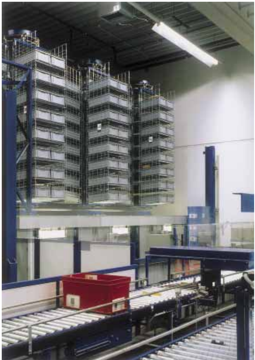
Horizontalkarusselle in Verbindung mit innerbetrieblicher Fordertechnik
