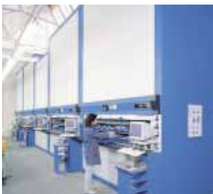
Kommissionierung mit Lager-Verwaltungs-System aus Umlaufregalen
