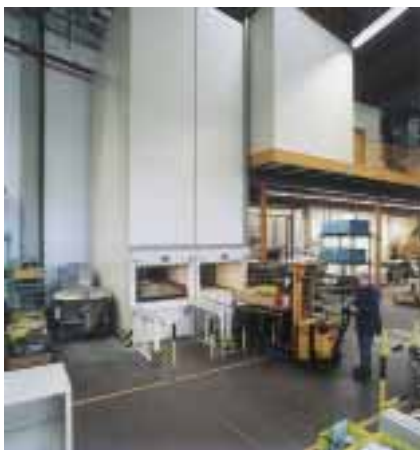
Liftsysteme mit Palettenlagerung
