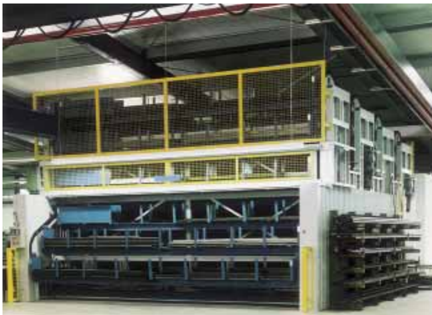
Sonderpaternoster als Schlangenpaternoster für Schwergutlagerung
