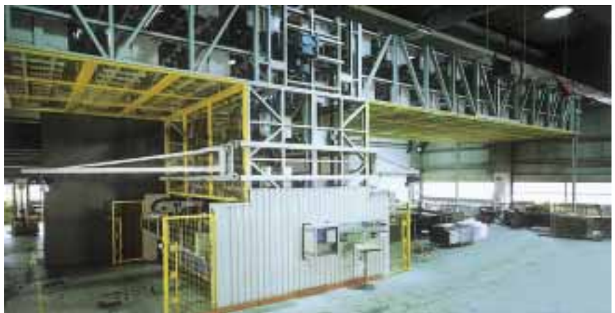
Sonderpaternoster als Brückenpaternoster
