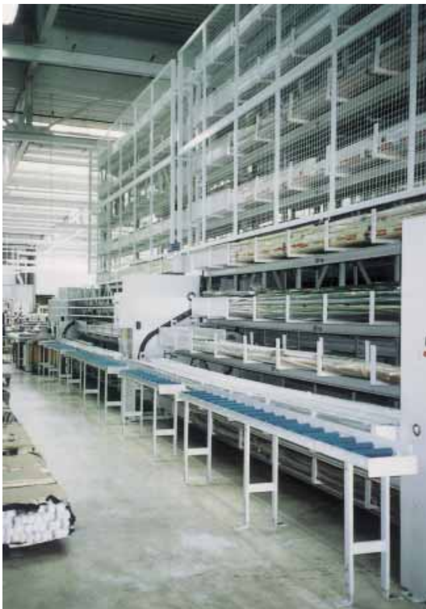
Sonderpaternoster für die Langgutlagerung mit Förderstrecke
