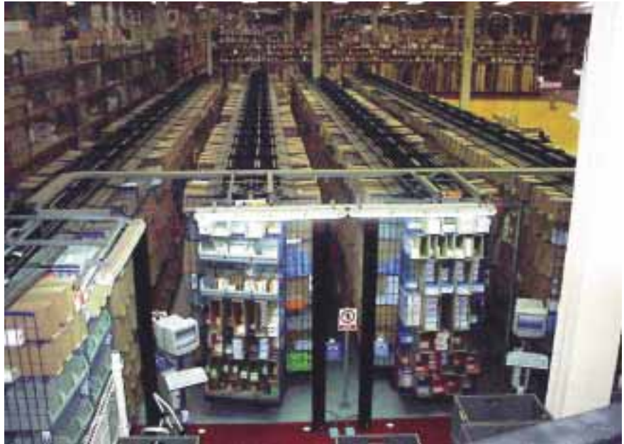
Horizontalkarussell im Pharmahandel fur die Arzneimittelkommissionierung
