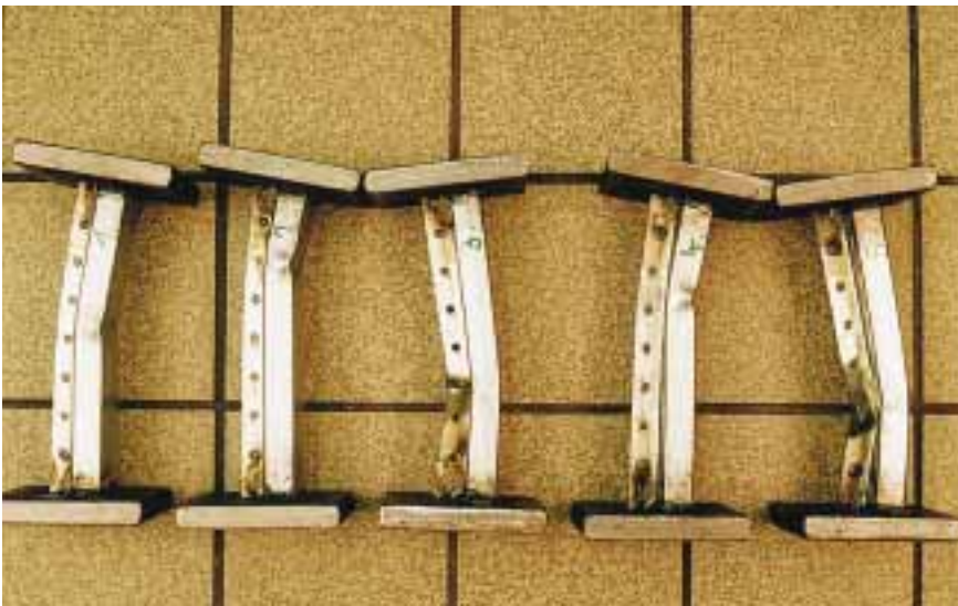
Abb. 4: Bruchbilder der gedrückten Stützenstücke mit unterschiedlichem Lastangriffspunkt
